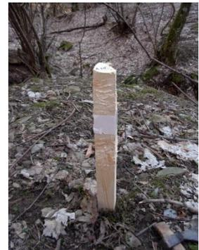
Il protocollo è consistito nel posizionamento sistematico dei 36 paletti divisi in 3 transetti (transetto A: 2,47 Km; Transetto B: 3,52 Km; transetto C 4,32 Km) con 12 paletti ciascuno. Questi sono stati posti ogni 250 metri circa seguendo una disposizione a dente di sega facendo in modo che un paletto fosse piantato sul sentiero, quello successivo, dopo 250m di percorso, deviato ortogonalmente di circa 20-50m a destra, quello successivo con lo stesso criterio sulla sinistra e così via:
