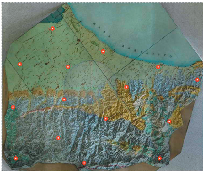
Figura 11 – Dislocazione dei 15 Punti Fotogrammetrici di Appoggio (PFA), necessari sia per la definizione metrica che per evitare effetti di deformazione del modello digitale tridimensionale.
