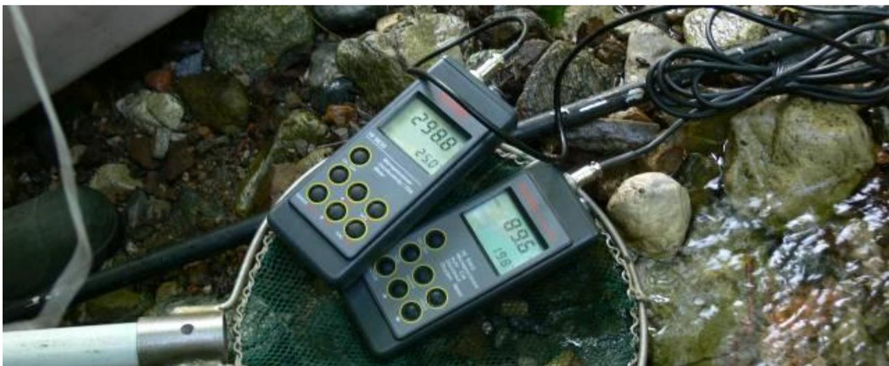
FIGURA 5-1. SONDE PORTATILI PER IL RILEVAMENTO DEI PARAMETRI CHIMICO-FISICI
