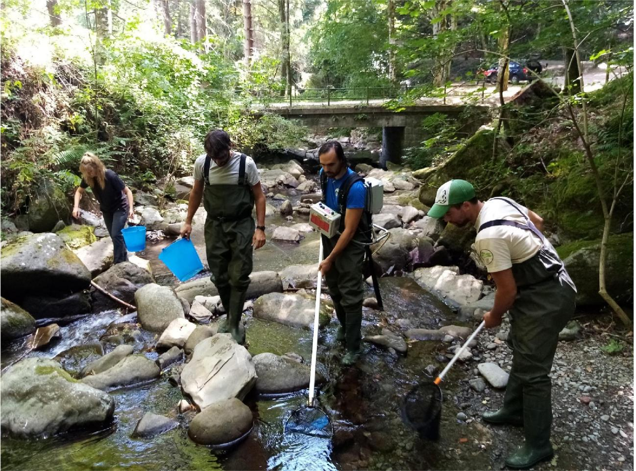
*Operazione di cattura attraverso pesca elettrica nella stazione di campionamento Camaldoli 688 m slm - CML03*
