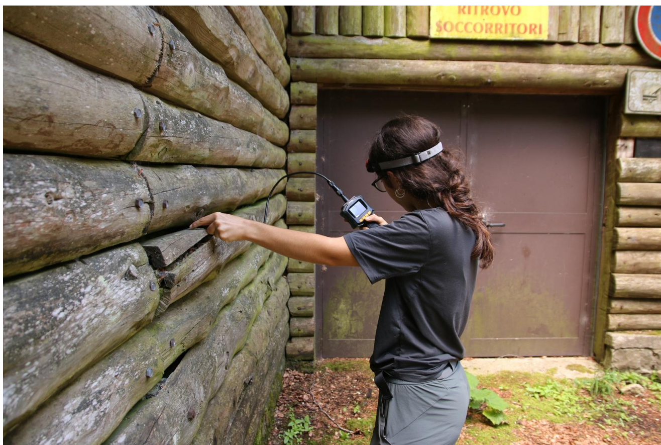
Figura n. 23 – Ispezione con endoscopio della parete nord-ovest dell’edificio (Sito n. 8)
