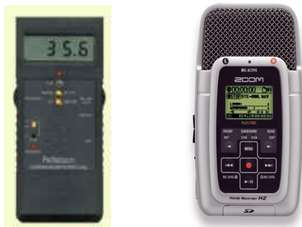
Figura 1. Il bat detector, a sinistra, e il registratore audio, a destra, utilizzati per i rilievi.
